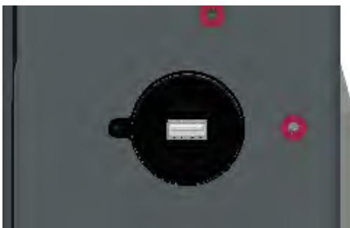
Abb. 6.3: USB-Schnittstelle an der linken Gehäusesseite
